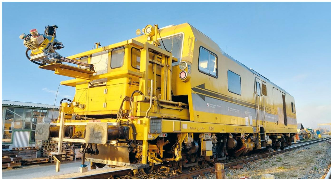
Abb. 1: Frontansicht des Messfahrzeugs EM SAT 120 mit MMS
