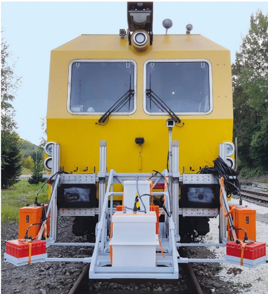
Abb. 2: Heckansicht des Messfahrzeugs EM SAT 120 mit Georadar-Antennen
