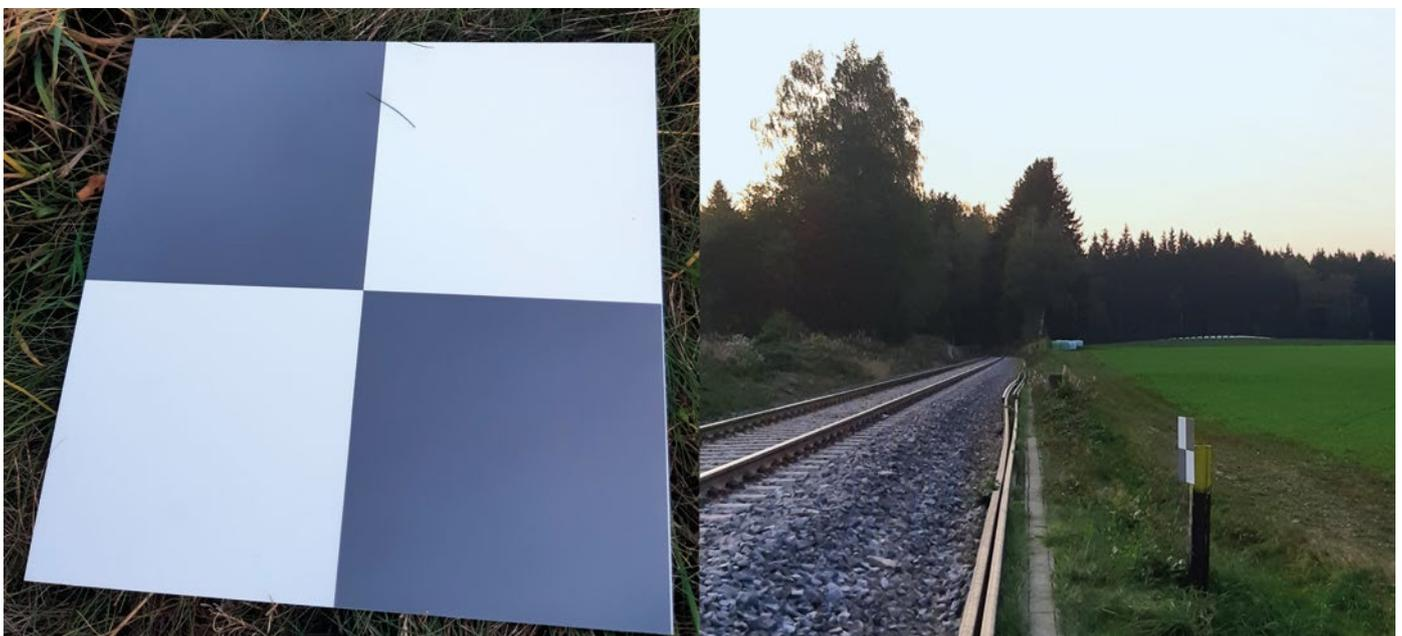
Abb. 3: Target (40 x 40 [cm]) zur Markierung von Referenzpunkten (li.); mit Target versehener Referenzpunkt (r.)
