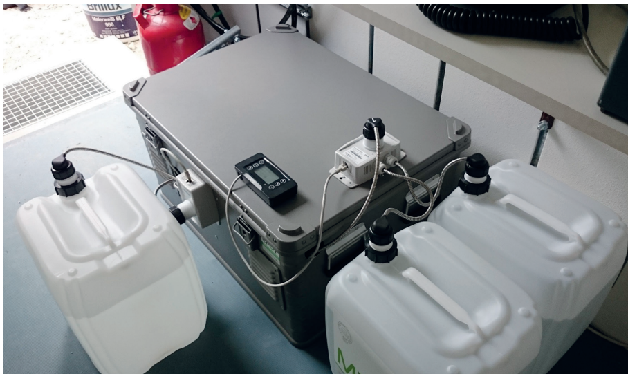
Abb. 3: DMFC – Brennstoffzellen-System mit Methanolbehältern
